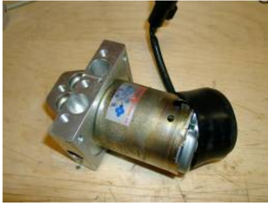
Abbildung 5: Montieren des Elektromotors – Lüftungsschlauch leider auf falscher Seite
