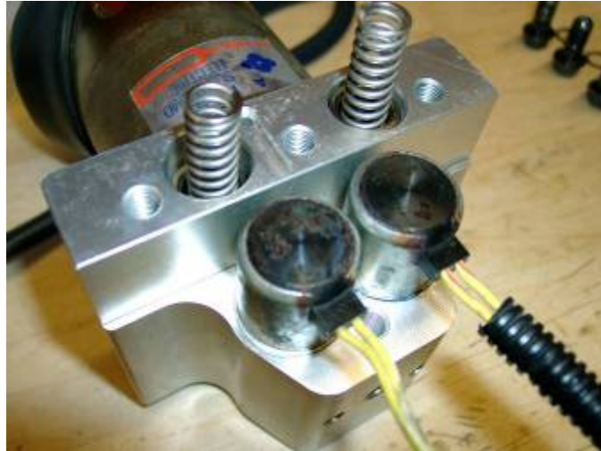
Abbildung 9: Einsetzen der Elektromagnetventile
