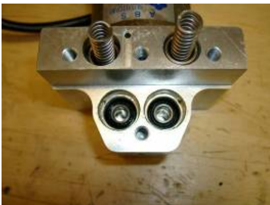
Abbildung 7: Einsetzen der Wegventilezylinder
