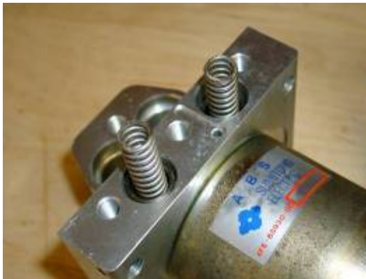
Abbildung 6: Einbau der Ausgleichkolben
